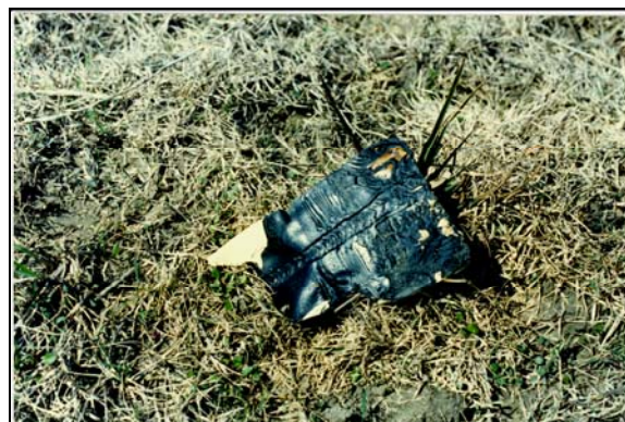
Cette photo illustre la façon dont le revêtement anticorrosion utilisé avec le Ruban Mastic 606 est conforme et remplit les vides.
