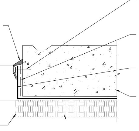
TERMINATION BAR AND FASTENERS SPACED 2" INWARD FROM EACH END OF TERMINATION STRIP AND NOT MORE THAN 8" SPACING BETWEEN FASTENERS
